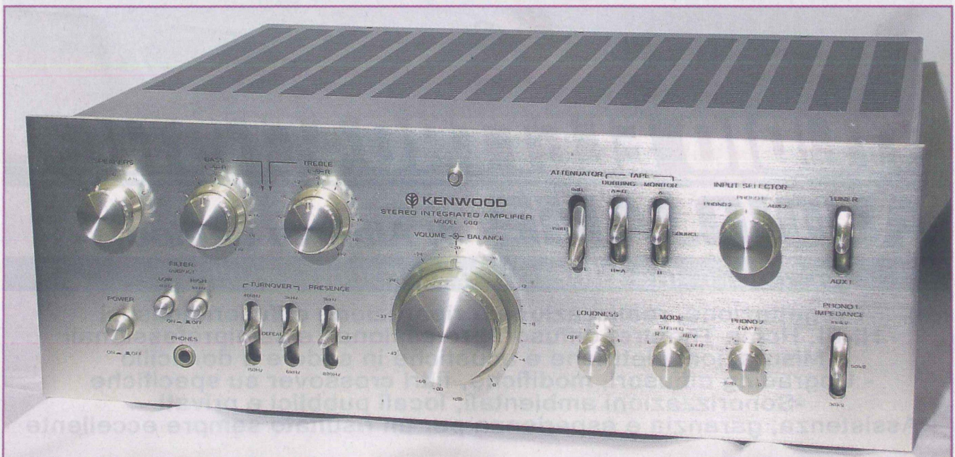
Foto 01 - Il Model 600 da davanti. Dettagli un po' barocchi ma forma nel complesso semplice e funzionale, con tutti i comandi posizionati in modo intuitivo; insolito, ma comodo una volta che ci si è fatta l'abitudine, il selettore ingressi a due stadi che dà precedenza su Aux 1 e Tuner; finiture di gran lusso con tutti i particolari in alluminio pieno
